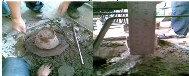
Fig. D Slump Cone
